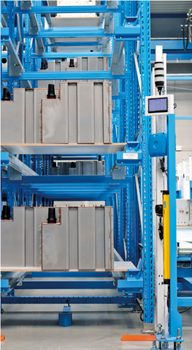
Auch beim Ein- und Auschecken ins Lager erfasst ein Schreiblesekopf die Produkte
